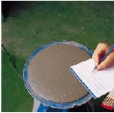
Гидравлическое испытание (UNI норма 7044/72)
